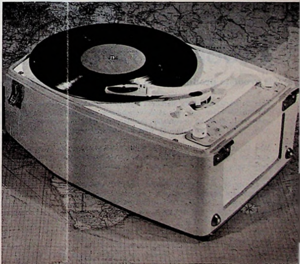
Dit is een afbeelding van Philips' transistor koffergramfoon met ingebouwde versterker, type AG. De voeding van deze gramfoon geschiedt uit vier droge batterijen van 1,5 V, waarmede ongeveer 3 gramfoonplatenweergave onafhankelijk van het lichtnet mogelijk is. De toepassing van transistor voor dit doel heeft o.m. de voordelen, dat de afmetingen en het gewicht konden worden beperkt en de batterijkosten gering zijn. Met de vier toegepaste transistors is een krachtige versterker met twee pen verkregen. (vdh).
